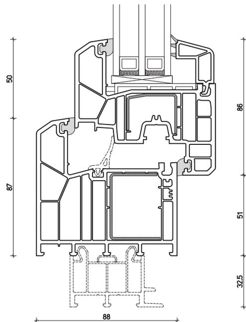
Mit dem System KBE-88 entscheiden sie sich für eine neues, qualitativ hochwertiges System, das ihnen ein Maximum an Lebensqualität bietet und dabei Wirtschaftlichkeit, Umwelt- und Wärmeschutz gleichermaßen berücksichtigt. Das 6-Kammer-System mit 88mm Bautiefe bietet Wärmedämmung auf höchstem Niveau bis hin zum optionalen Ausbau zur Passivhaustauglichkeit.
